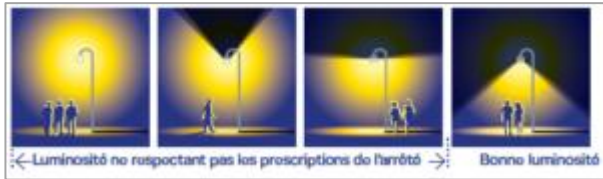
Orientation du flux lumineux selon l'arrêté 2018
