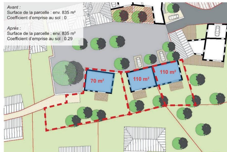
Plan des RDC faisabilité architecturale densification par artificialisation UB
