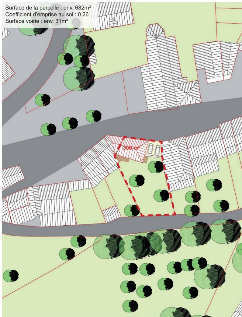
Plan masse projet exemple (0533) pour la densification par reconfiguration
